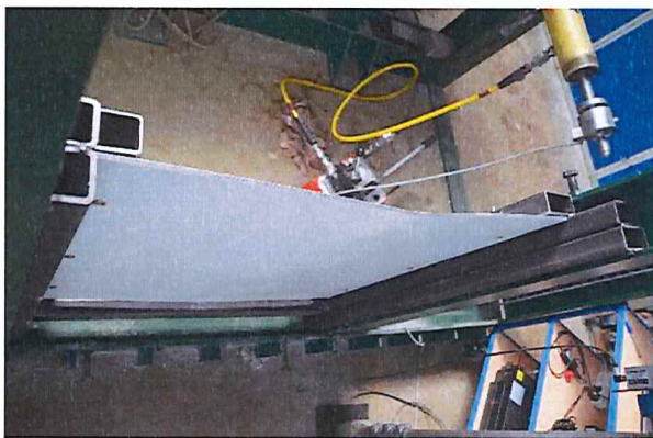
Abbildung 6: plastische Verformung in Feldmitte am oberen freien Rand infolge einer Anprallenergie von 100 Nm
