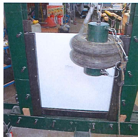
Abbildung 5: Versuchsaufbau einer stoßartigen Beanspruchung im auflagernahen Bereich
