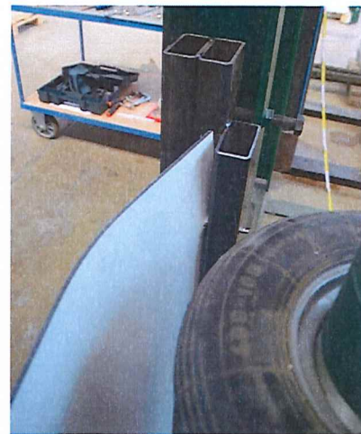
Abbildung 7: plastische Verformung im auflager-nahen Bereich am oberen freien Rand infolge einer Anprallenergie von 100 Nm
