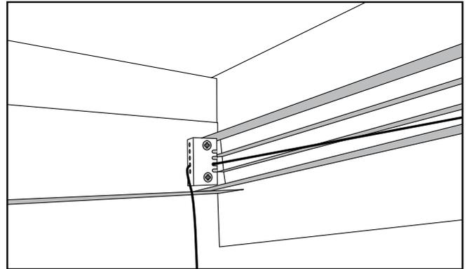
**Schritt 3:** Schrauben Sie die 4 Schnurhalter in die Ecken. Die Löcher sind bereits vorgebohrt. Legen Sie das Plissee ungeöffnet mittig in die Schienen.
