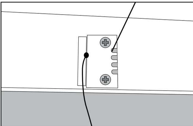
**Schritt 4:** Spannen Sie dann die Schnüre in den 4 Ecken. Ziehen Sie hierzu die jeweilige Schnur stramm und schlagen anschließend die Sperre mit einem Hammer in die Löcher. Bitte achten Sie darauf, dass Sie beide Seiten gleich stark spannen, damit das Plissee gerade hängt.
