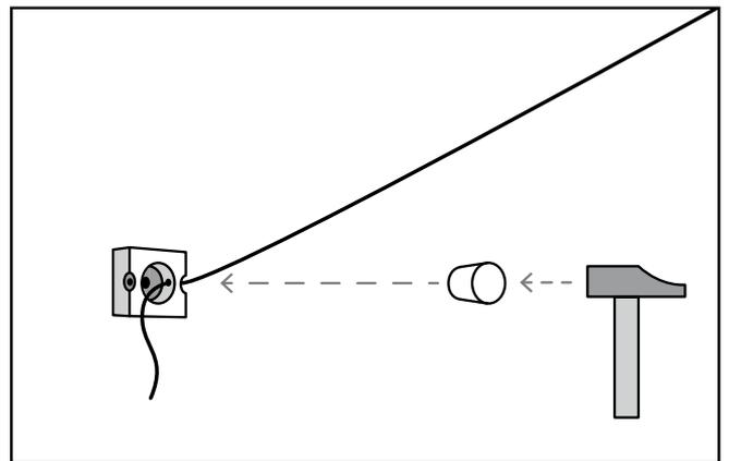
**Schritt 5:** Wickeln Sie nun die beiden mittleren Schnüre ab und fädeln diese jeweils oben und unten durch die beiden Verriegelungsblöcke. Ziehen Sie die jeweilige Schnur auf Spannung und schlagen Sie die Sicherung mit einem Hammer hinein. Achten Sie bitte auch hier darauf, dass beide Schnüre die gleiche Spannung besitzen.
