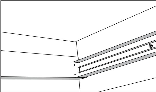
**Schritt 1:** Kleben Sie zuerst die beiden kurzen Profile zwischen die jeweiligen Dachsparren. Es wird empfohlen, diese beiden Profile zusätzlich zu verschrauben.
