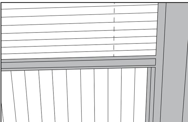
**Schritt 6:** Falls das Plissee nicht gleichmäßig schließt und öffnet, müssen Sie die Spannung der einzelnen Schnüre anpassen. Danach können Sie alle Schnüre mit einem doppelten Knoten versehen und die überschüssige Schnurlängen abschneiden.
